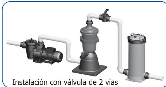
Si el MultiCyclone es instalado como un prefiltro para un filtro de arena, la corriente de agua para el filtro de arena puede ser cerrada por la vía de la válvula multipuerto del filtro de arena.\*
