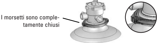
FIGURA 4 - Installazione morsetto
