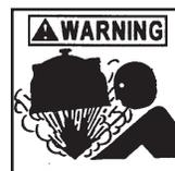
Si le dispositif Ring-Lok du filtre n'est pas serré jusqu'au "point d'arrêt incorporé", le couvercle du filtre pourrait éclater et causer des blessures ou des dommages.
