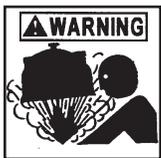
• Votre filtre est un appareil à pression; il ne faut donc jamais effectuer les travaux d'entretien quand l'appareil est sous pression. Fermez toujours la pompe pour faire chuter la pression dans le filtre ouvrez la purge d'air avant tout travail d'entretien.
